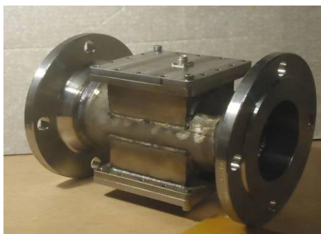
Рис. 1. Опытный образец измерительной камеры СВЧ влагомера нефти и нефтепродуктов
